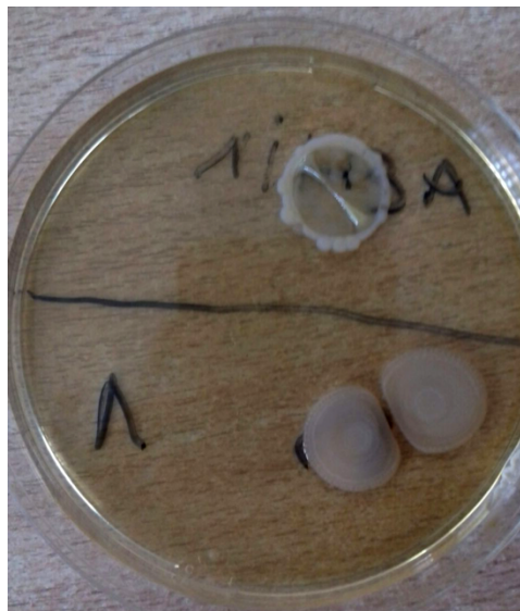
Рис. 1. Чашка Петрі з досліджуваною контактною лінзою (зверху) та розчинами для лінз: який вчасно змінювався (знизу зліва), який не змінювався протягом 4 діб (знизу справа)
