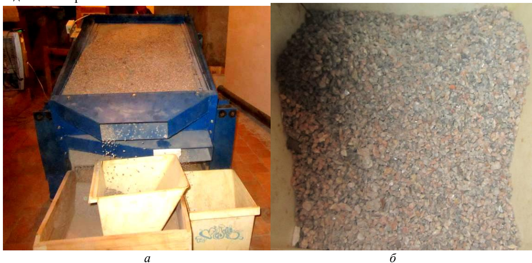
Рис. 5 – Экспериментальное определение производительности грохота: а – виброгрохочение материала на стенде; б – навеска гранотсева.
