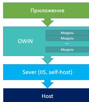
Рис. 2 Схема організації веб сервісу з використанням OWIN
