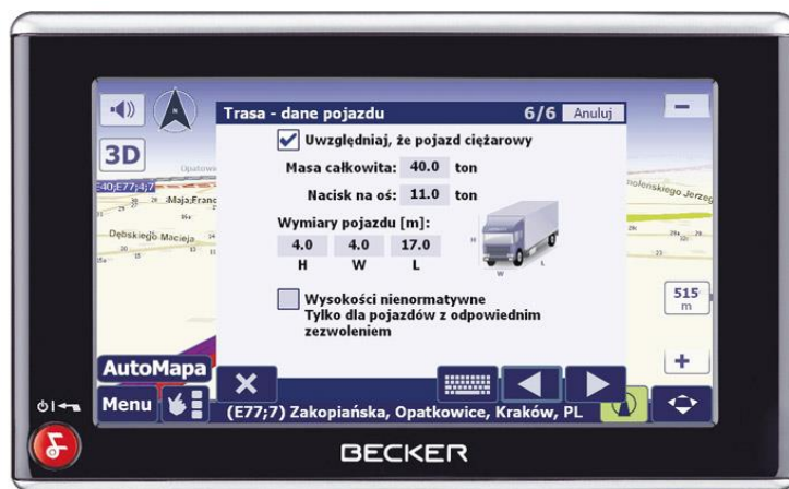
Rysunek 4. Interfejs cyfrowej mapy drogowej umożliwiający wprowadzenie parametrów pojazdu
