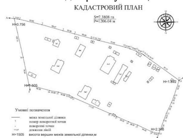
Рисунок 9 — Приклад одного із можливих варіантів відображення висотної основи на кадастрових планах.
