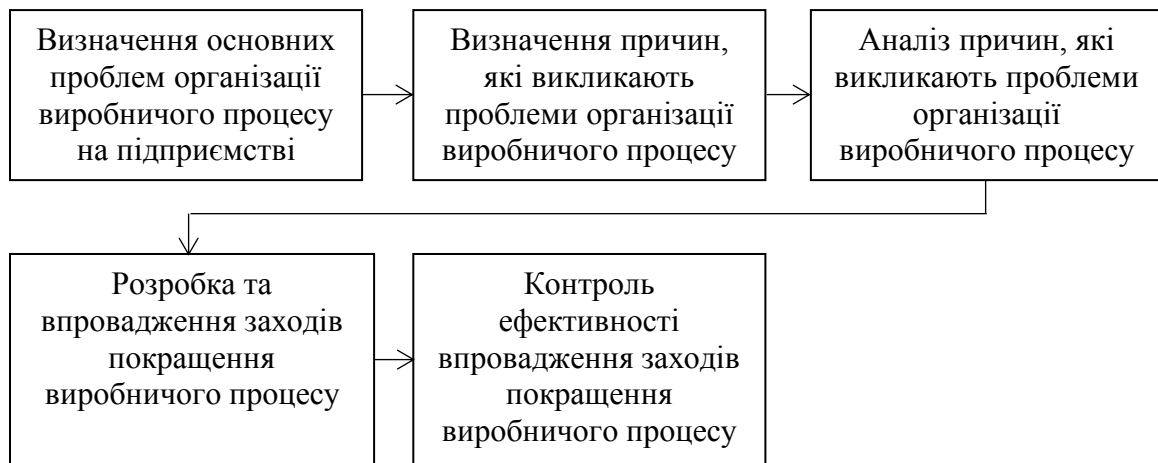
Рис. 1. Покращення виробничого процесу машинобудівного підприємства на основі методів концепції «Шість сигм»
