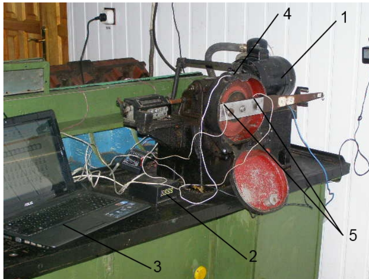
Рис. 1. Загальний вигляд експериментальної установки 1-машина тертя МИ-2, 2-перетворювач, 3-ПОМ, 4-індукційний датчик обертів, 5-термопари.
