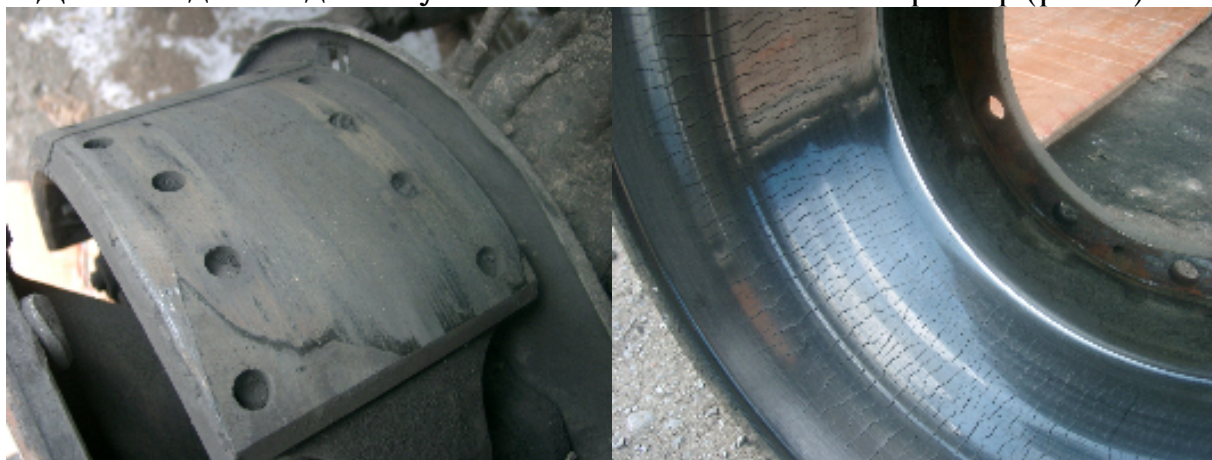
Рис. 2. Стан гальмівної колодки та барабану автомобіля КамАЗ, пробіг 44168 км
