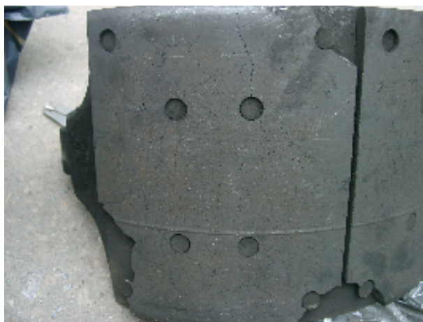
Рис. 2. Стан гальмівної колодки автомобіля КамАЗ, пробіг 42467 км
