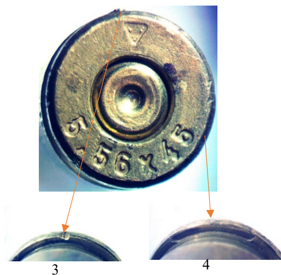
Рисунок 3. Гільза зі слідами двох зачепів: 1 – пістолета, 2 – карабіна.
