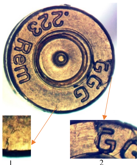
Рисунок 2. Гільза зі слідами двох відбивачів: 1 – пістолета, 2 – карабіна.
