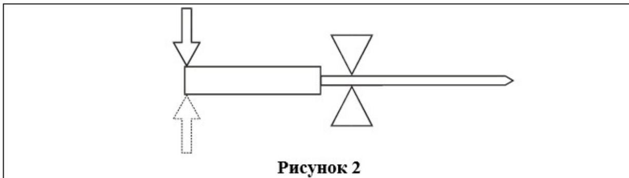
Міцність конструкції вузла з'єднання клинка з руків'ям визначається так: ніж затискається за клинок в 10 мм від місця з'єднання з руків'ям. До верхнього краю руків'я прикладається зусилля 5 кг в напрямку, перпендикулярному площині клинка в обидві сторони. Після випробування не повинно бути: залишкової деформації, виникнення люфтів, руйнування деталей та механізмів ножа. Випробування проводиться не менш трьох разів відносно кожного предмету (рис. 2).
