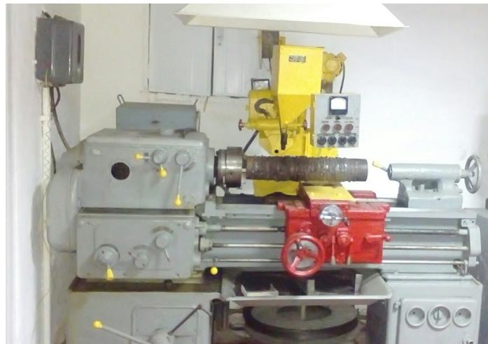
Рис. 1. Установка для наплавлення під шаром флюсу А-580М
