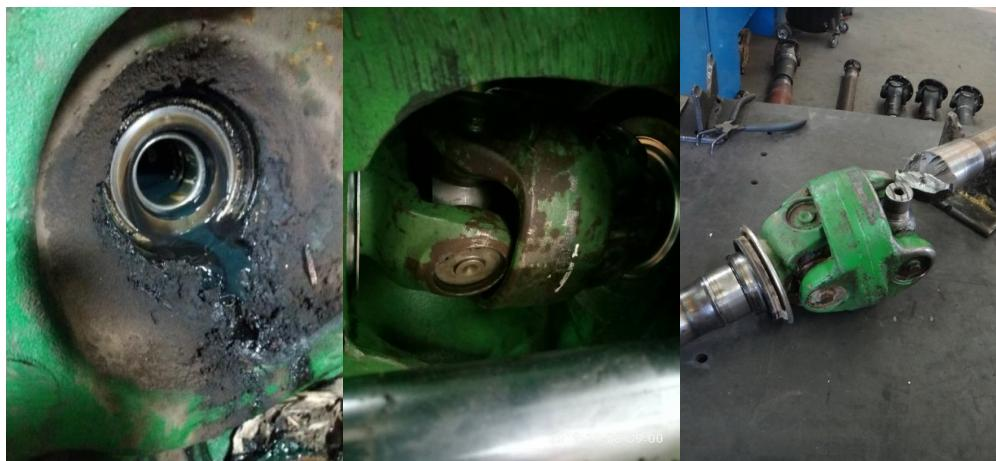
Рис. 3. Підтікання сальника переднього бортового редуктора, та розбиття підшипника шипа хрестовини
