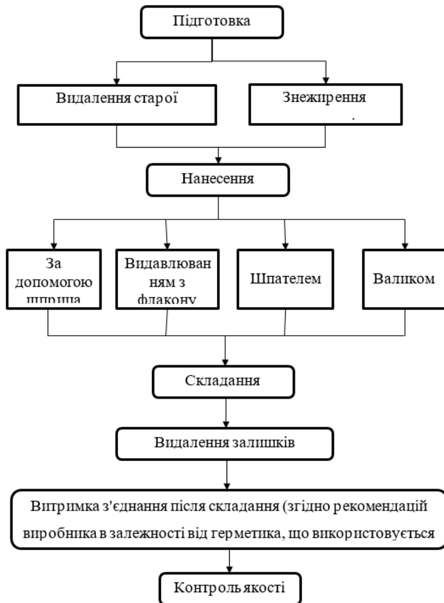
Рис. 2. Технологічний процес герметизації нерухомих з'єднань агрегатів
