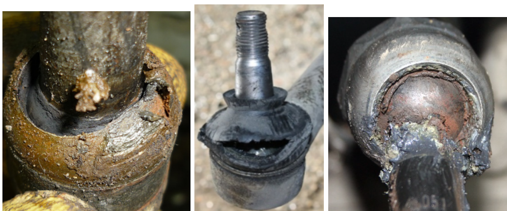
Рис. 2. Стан кульових опор та наконечників рульового керування
