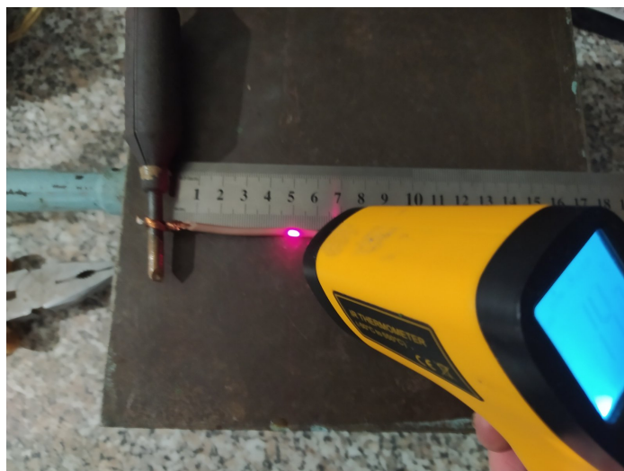
Рис. 3. Процес моделювання температурного впливу на електропровід
