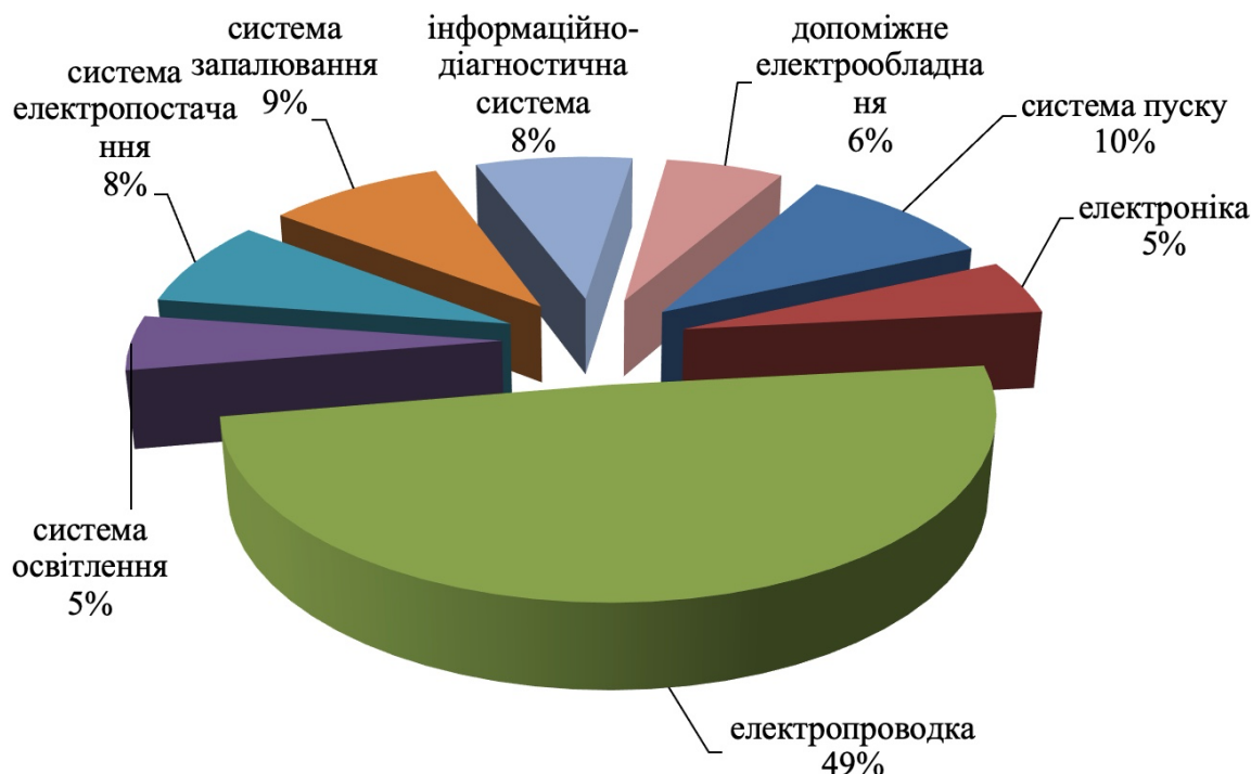
Рис. 2. Структура відмов елементів системи електрообладнання
