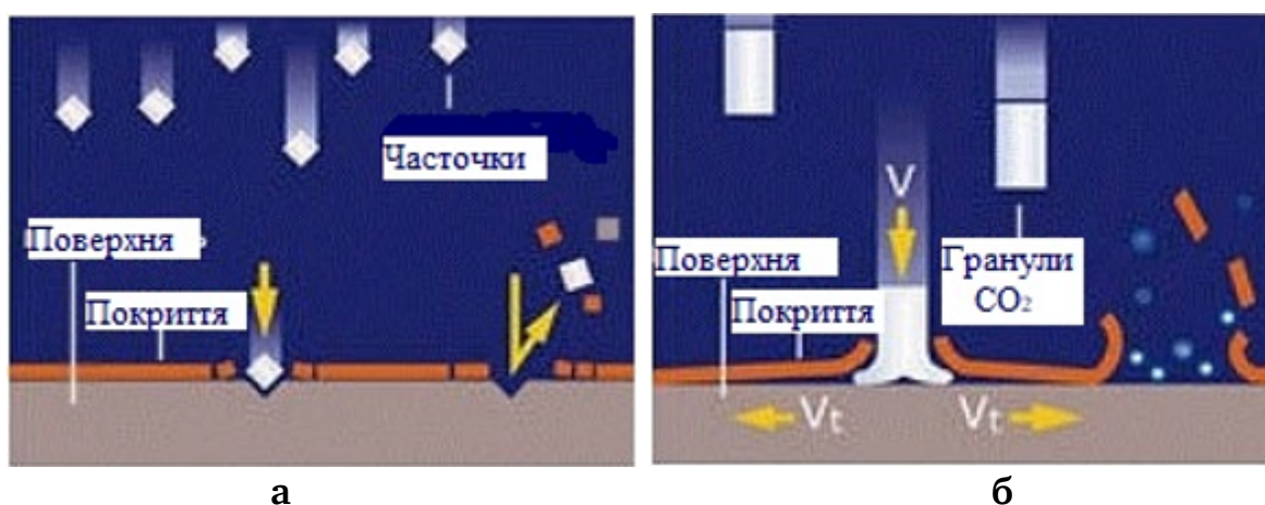
Рис. 1. Порівняння методів очищення а – абразивна очистка, б – очищення льодом
