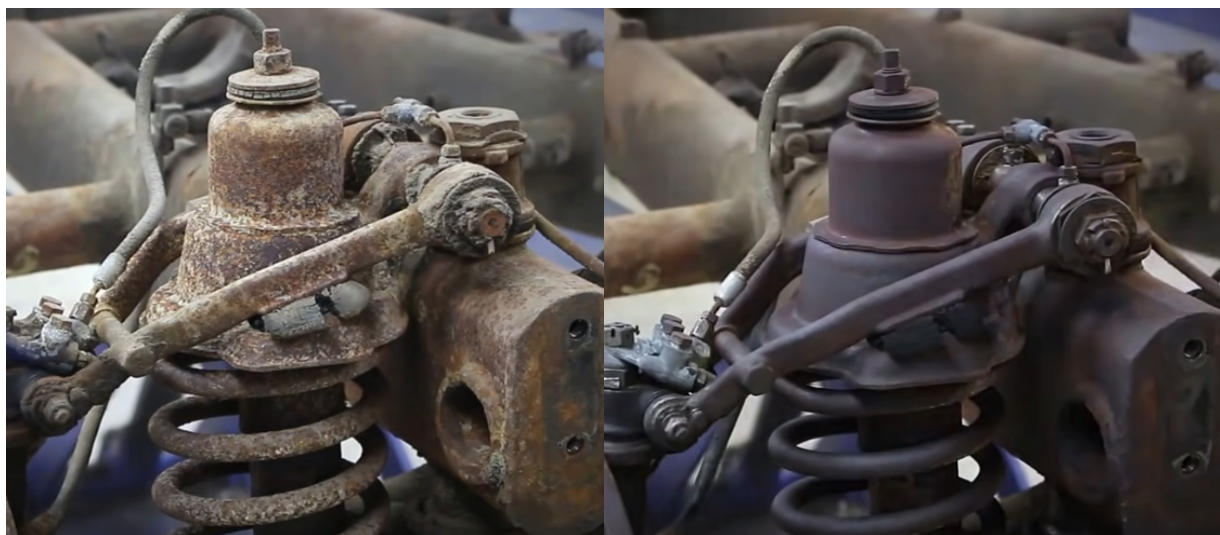
Рис. 2. Приклад очищення поверхонь льодовим струменем
