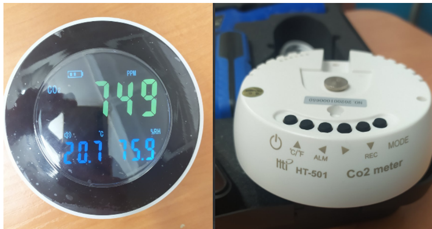
Рис. 7. Вимірювальні прилади: Testo 535 та Hti ht-501
