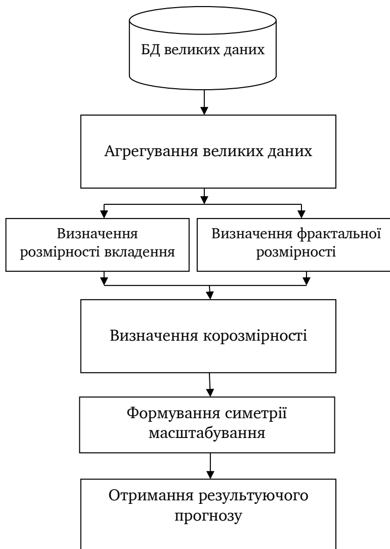
Рис. 1. Структурна схема реалізації системи моніторингу та управління для інфраструктури великих даних
