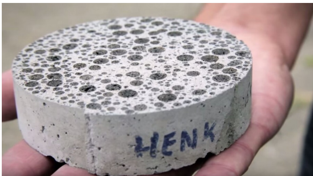
Рис. 2. Біобетон Хенка Йонкерса.
