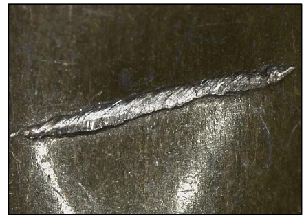
Зображення 4. Слід від ребра кришки ствольної коробки
